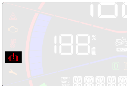
Fig. 27 – Défaillances du groupe motopropulseur.
