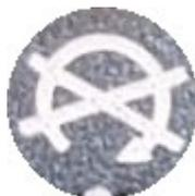
Toutes les fonctions sont désactivées, le blocage de la direction n'agit pas (le scooter peut alors être déplacé). Travailler sur le véhicule peut se faire sans risque (il est recommandé dans tous les cas de retirer les clés).
